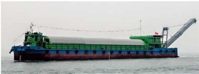
2000 吨级内河纯电动自卸散货船
